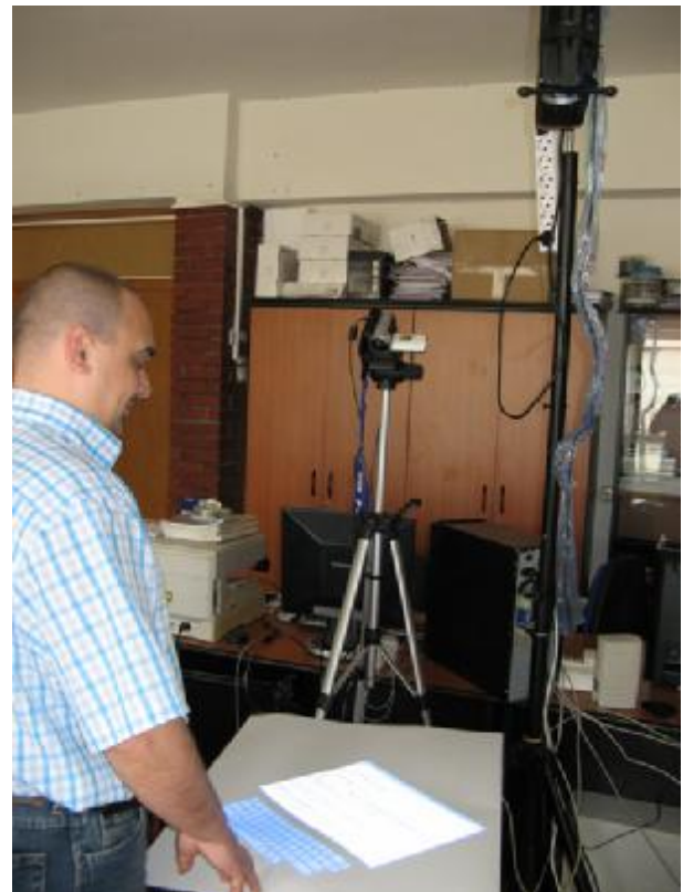
Fig. 4. Detecția și urmărirea unui utilizator în jurul instalației tabletop: ferestrele sunt automat reorientate în funcție de poziția utilizatorului.
