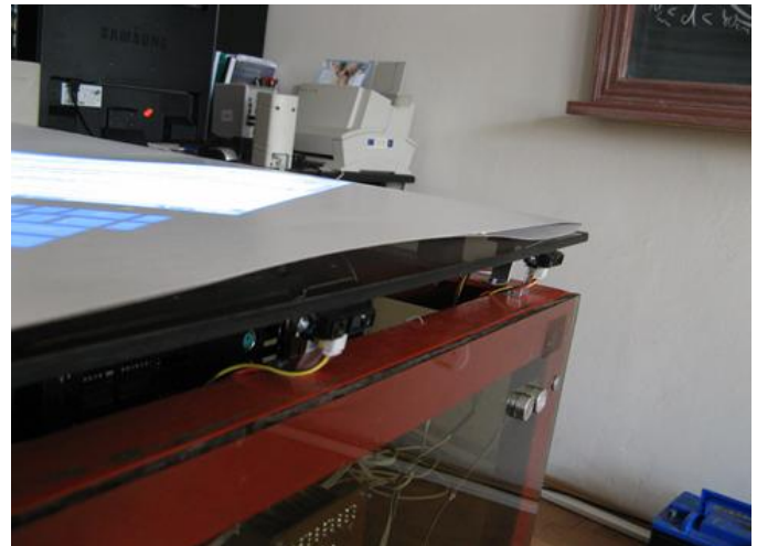
Fig. 1. Prototipul tabletop: instalarea senzorilor în jurul mesei.
