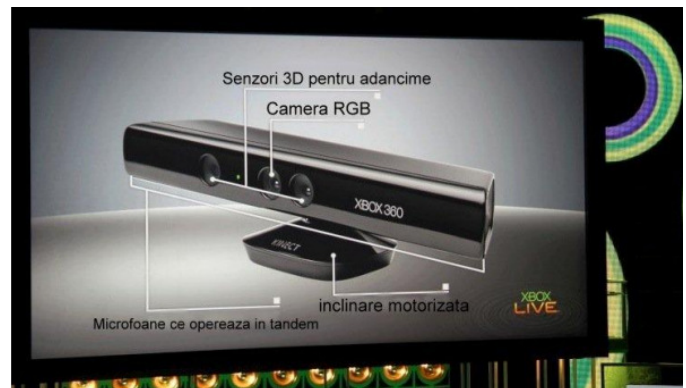
Fig. 1. Senzorul Kinect – părți componente.
